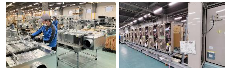
オフサイト生産(日本ビルコンでの機器のユニット化)
