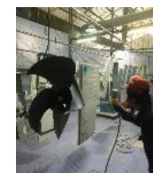
塩害塗装の様子
