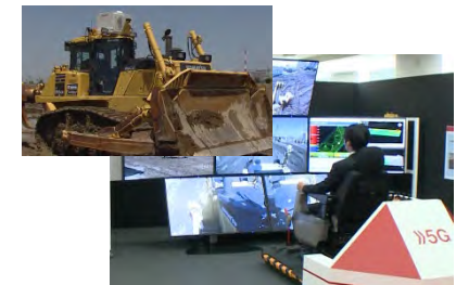
建設機械等の遠隔操作
