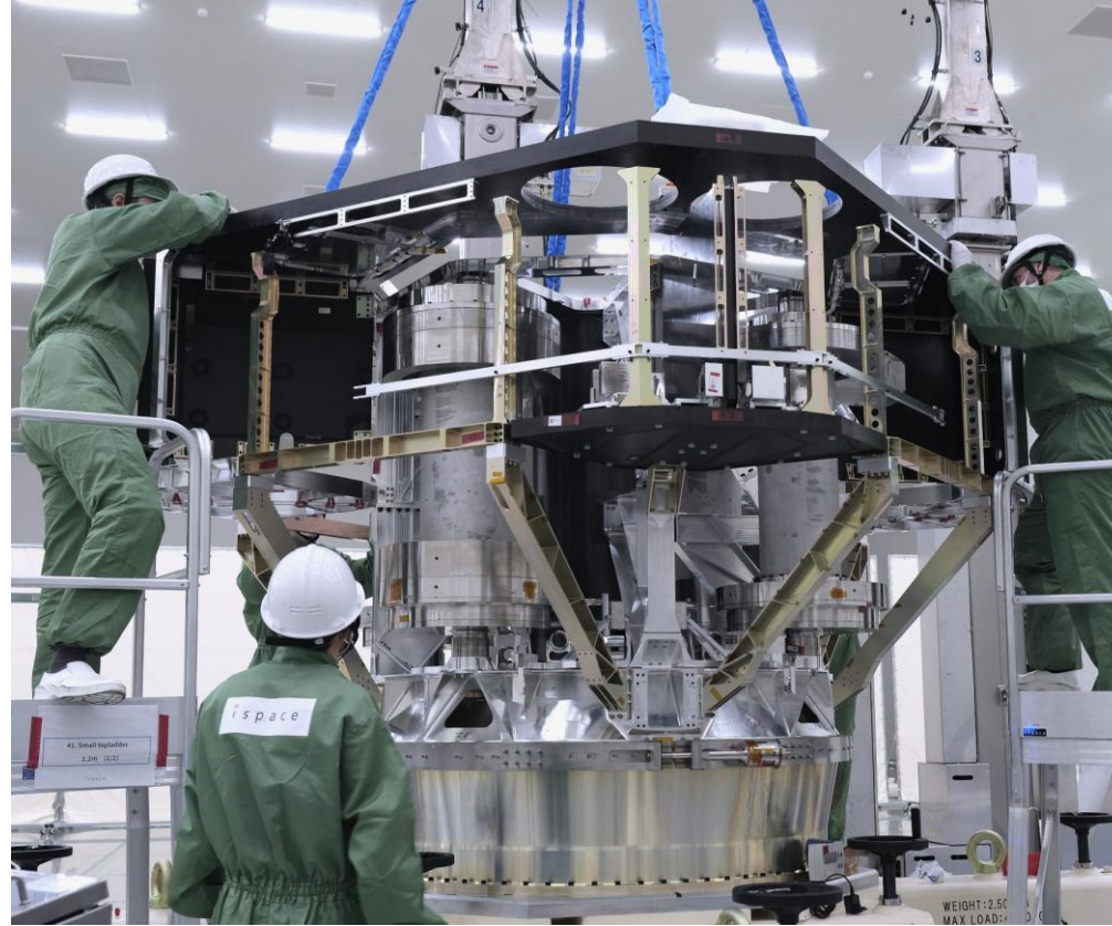
経産省SBIR事業の補助により開発中のULTRAランダーの最新の構造モデルの写真
