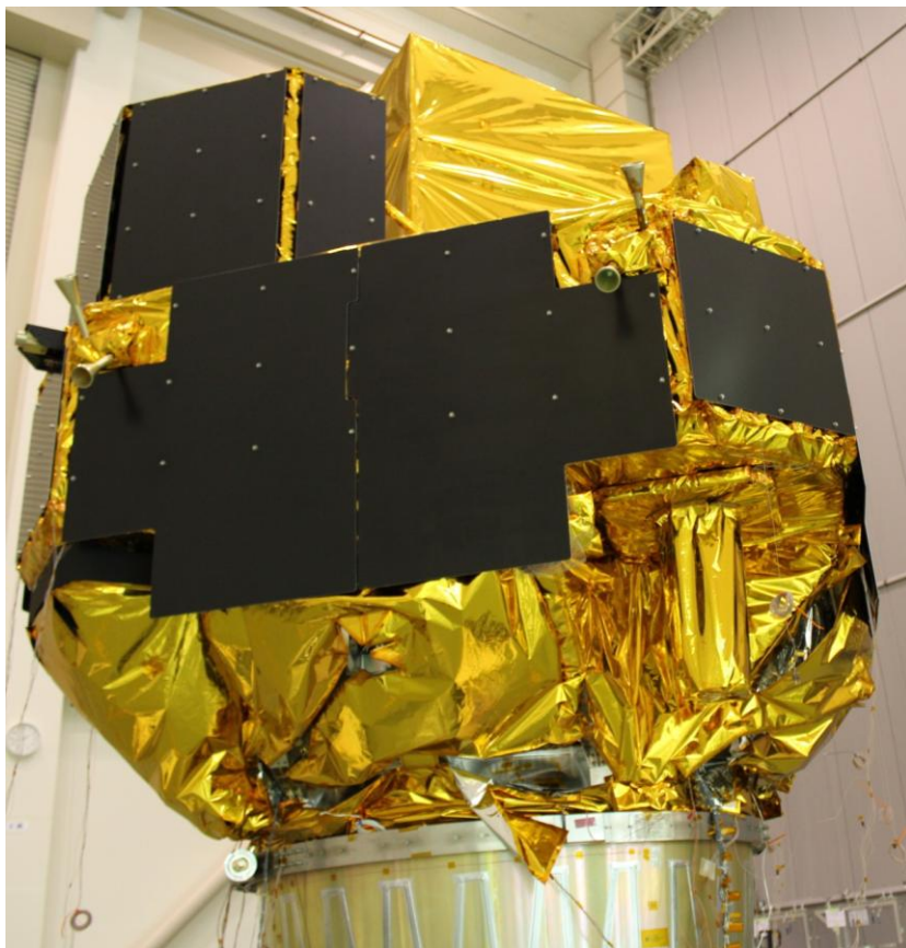
経産省SBIR事業の補助により開発中の 仮称Series 3ランダーの最新の熱構造モデルの写真
