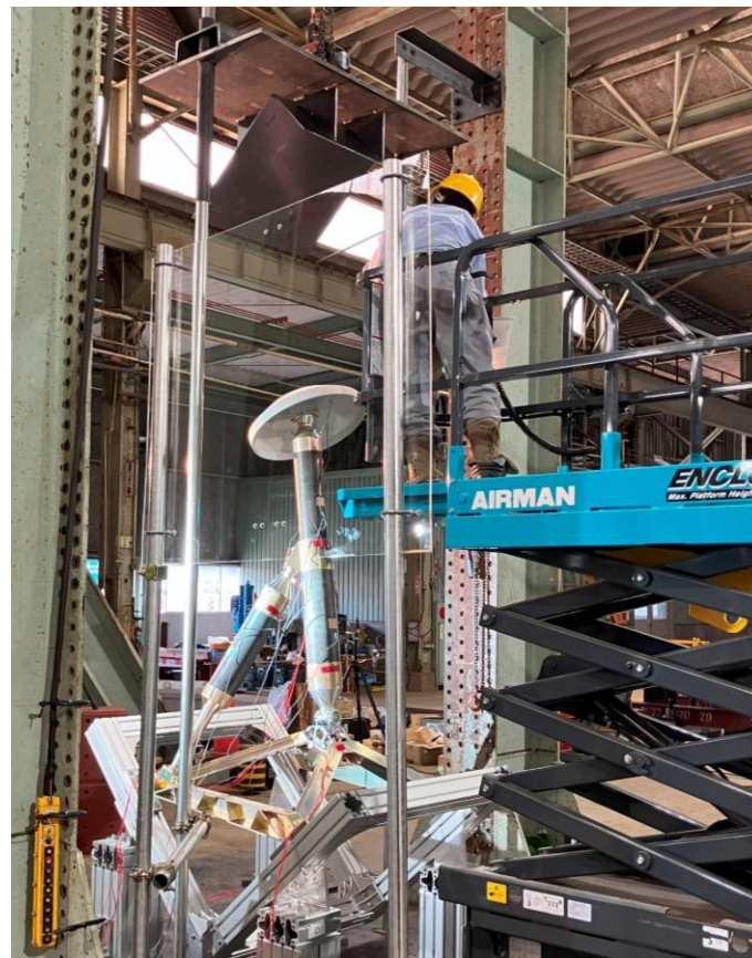
経産省SBIR事業の補助により開発中の 仮称Series 3ランダーの落錘試験の様子
