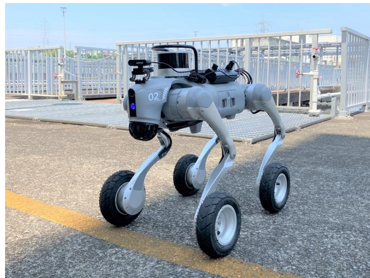
当社が巡視点検で活用しているロボットの一例
