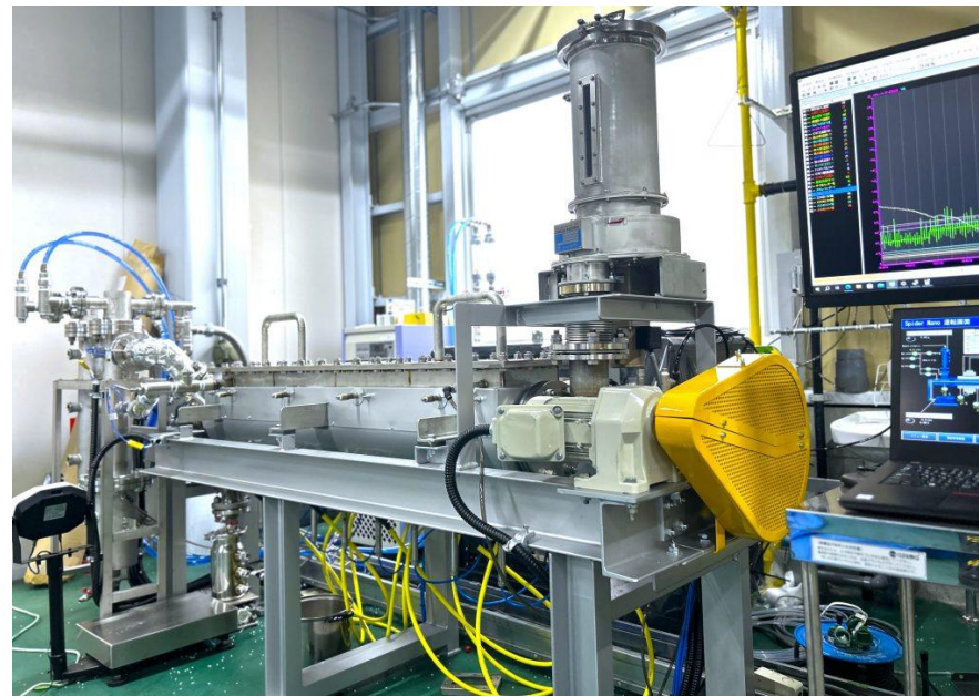
マイクロ波を用いたケミカルリサイクルの連続式実証機
