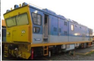
保守用車(レール探傷車)に搭載
