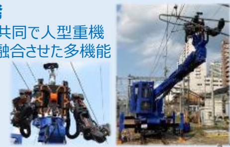
〔左〕人型重機ロボット、〔右〕多機能鉄道重機 12
