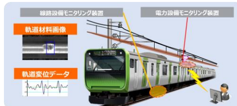
CBM（地上設備モニタリング）
