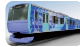
ハイブリッド車両 (燃料電池) 試験車両
