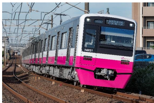
正面および側面行先表示器にセレクトカラーLEDを採用
