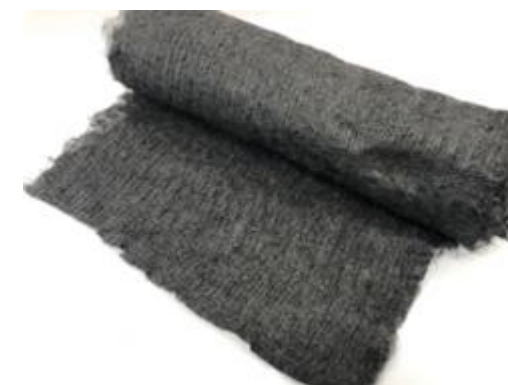
ミライ化成 : CFRPから炭素繊維を取り出し再利用
