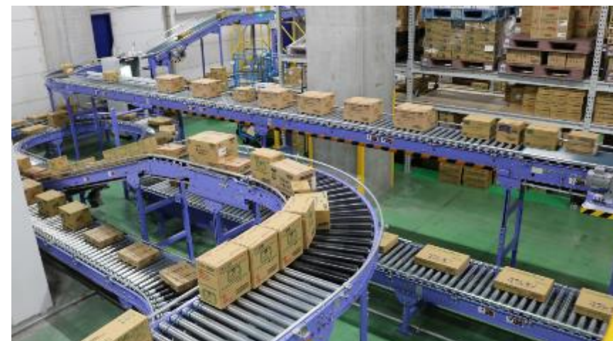
自動出荷ライン（昭島ドライセンター）
