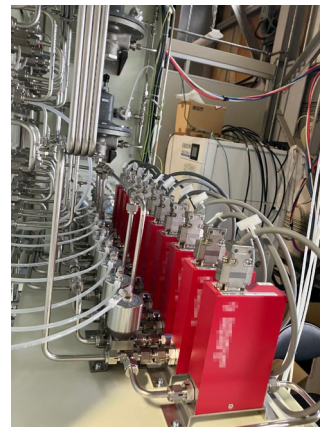
エル・テール製造の多種混合ガス 精密流量制御機構の一部
