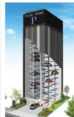
エレベーター方式・ くし歯式立体駐車場
