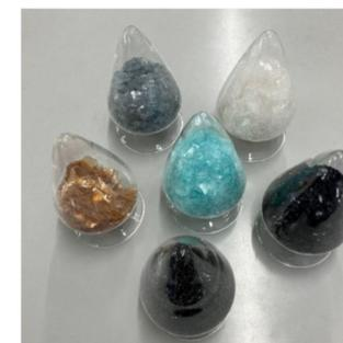
当社のホーローは、鉄にガラス質の釉薬を吹き付け、高温で焼き付けて作られます。釉薬は、ホーローの品質を左右する重要な原料で、ガラスの粉末に添加物を加えて作られますが、当社では釉薬に使われているガラスフリットも自社で独自に開発・製造。その高い技術力を生かして、自社用だけではなく、さまざまなニーズに合わせてオリジナル製品を提供しています。
