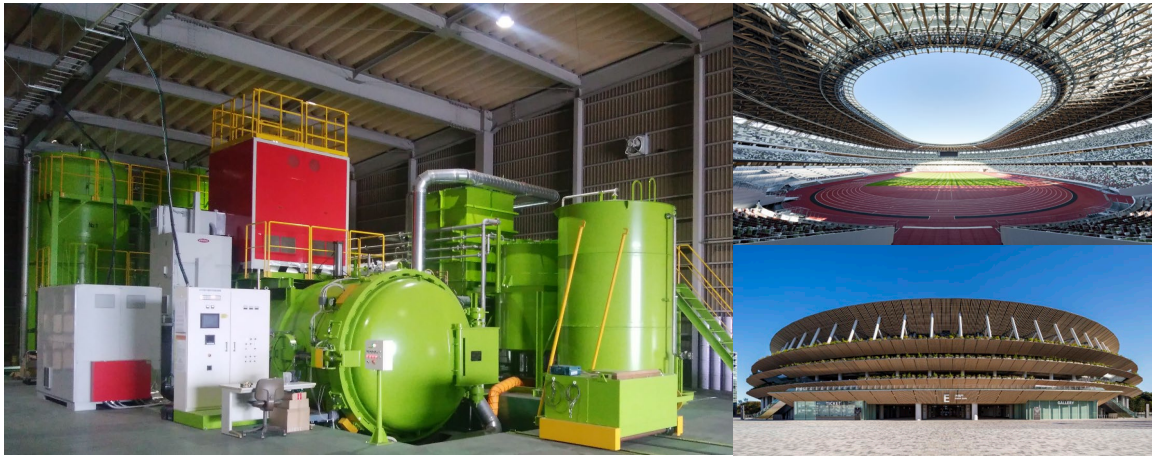
世界最大級の乾式木材保存処理装置
