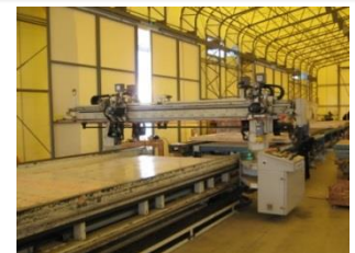
パネルシージングライン (自動釘打ちマシン)
