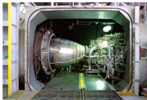
角田宇宙センター HATS低圧室のロケットエンジン
