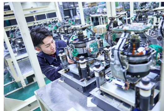
矢板工場：ジャイロコンパスの性能テスト
