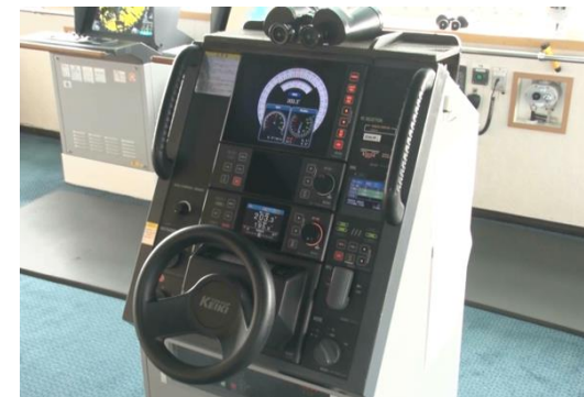
オーシャントランス様のフェリー「びざん」に搭載されている当社のオートパイロット
