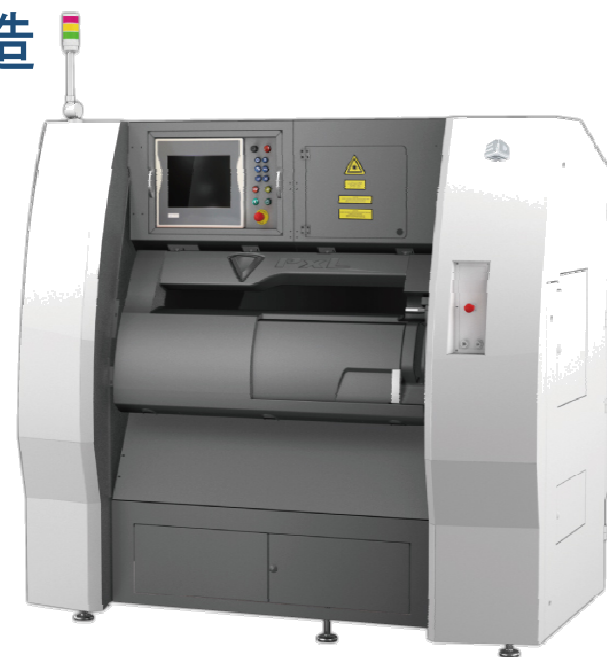
3D Systems社製 3Dプリンター「ProX300」 最大造形サイズ 250 mm × 250 mm × 300 mm
