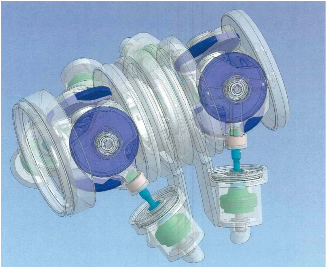
フルトロイダル トラクション機構
