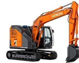
日立建機 13トンクラス電動油圧ショベル「ZX135-7EB」
