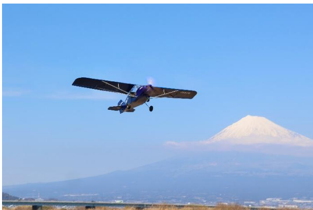
自動飛行試験(OPV試験)
