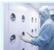
清潔な作業着に着替え、細かなゴミもエアシャワーで吹き飛ばす
