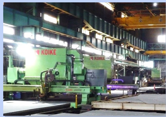
(NCプラズマ切断機)
