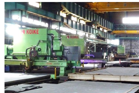
(NCプラズマ切断機)
