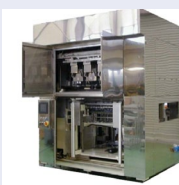
液晶パネル張合せ ODFUV 硬貨装置
