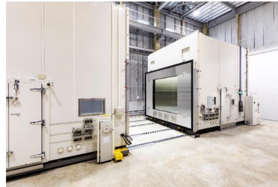
恒温(恒湿)室は可動式になっており、試験用建材の入れ替えが容易にできます
