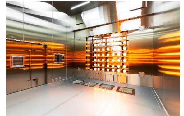
照射装置と散水(降雨)装置を装備し、屋外の気象環境を再現します
