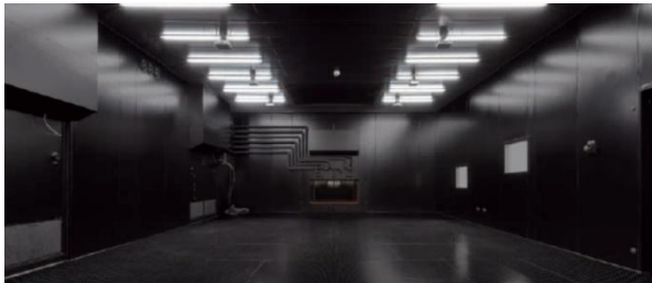
試験室 幅6m×奥行9m×高さ3m 光の乱反射を抑える黒色コーティング
