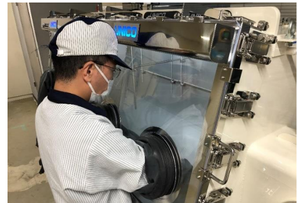
セル解体用グローブボックス
