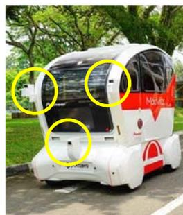
実証実験用のシャトルバスには、当社3D-LiDARセンサーが4つ搭載され、高精度の物体認識と自車位置推定を行う
