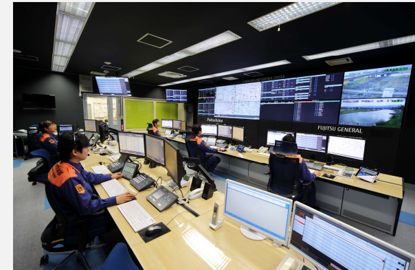
情報通信システム： 高機能消防指令システム
