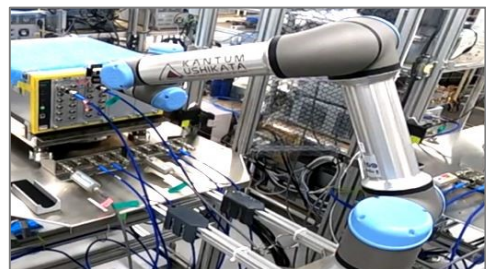
通信計測器用検査ロボット
