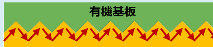
有機基板 表面の粗さは約 2\mu\text{m} (スキム深さは28GHzで約 0.4\mu\text{m} )
