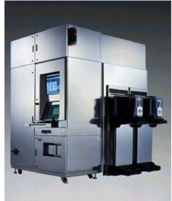
半導体ウエハ欠陥検査装置のイメージ図
