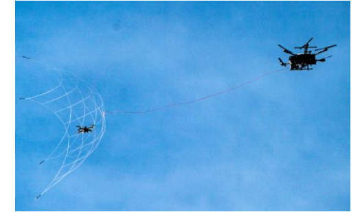
カウンタードローン セキュリティシステム
