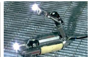
原子炉格納容器内部調査ロボット
