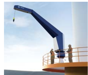
洋上風力発電向けの荷役作業を担うダビットクレーン（現在開発中）
