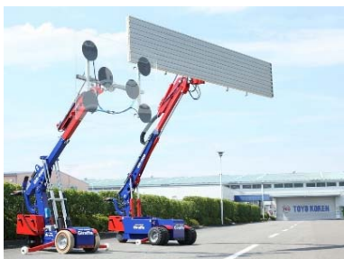
トヨーコーケン社 新製品 ガラス・パネル取付用 マニピュレーター「ジラフ」
