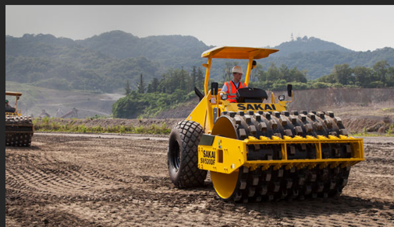
大型土工用振動ローラ 道路基礎工事、造成・ダム等の大型土木工事に使用
