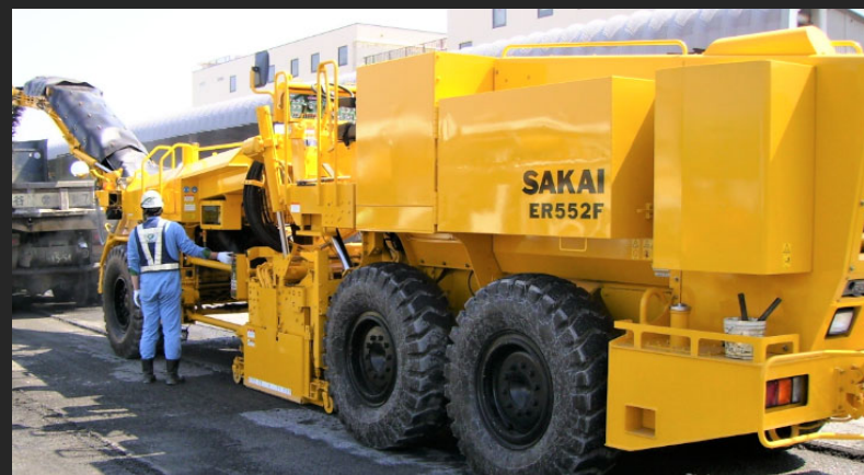
ロードカッタ 道路補修工事に使用 傷んだ既設路面を幅2m/深さ15cmで切削する
