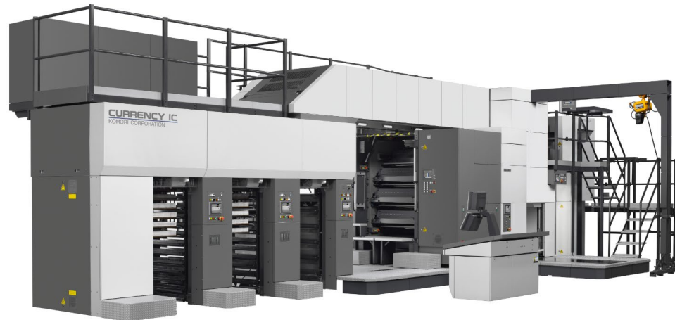
Currency IC (四六半裁凹版印刷機)
