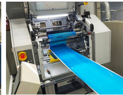
●LIB向けPPセパレータ塗工例 （※ダミーインク使用）
