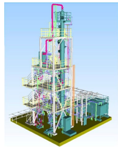
アンモニア処理装置
