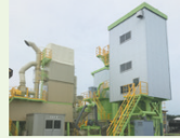
石膏系固材製造設備 石膏粉を乾燥し半水石膏を製造。 セメントや石灰とブレンドし固 材を製造する設備です。
