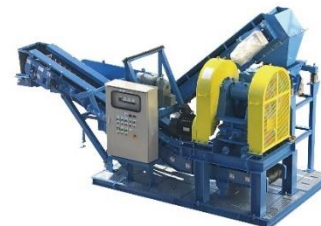
投入から排出までを一体化した 小型ユニット式破碎機
