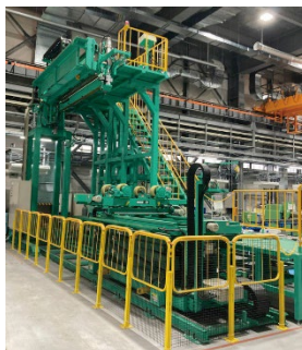
大型クランプシーマ (長手溶接)
