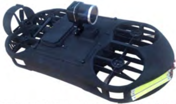
管路等閉鎖性空間調査点検用ドローン Air Slider .
