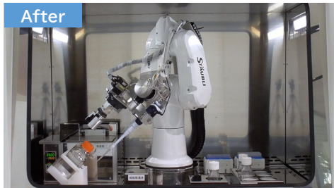
After アイソレータ庫内にロボットを組み込み 高浄度環境下でのラボ作業を自動化
