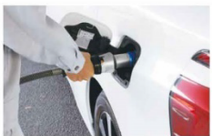
水素ステーションに設置され、 燃料電池自動車に高圧水素を充てん
