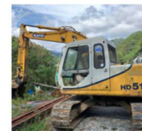
種類：ユンボ(油圧ショベル) メーカー：加藤製作所 型式：HD512E 年式：1998年 稼働時間：4,728時間 状態：ガラス破損、カバー開閉不具合あり
