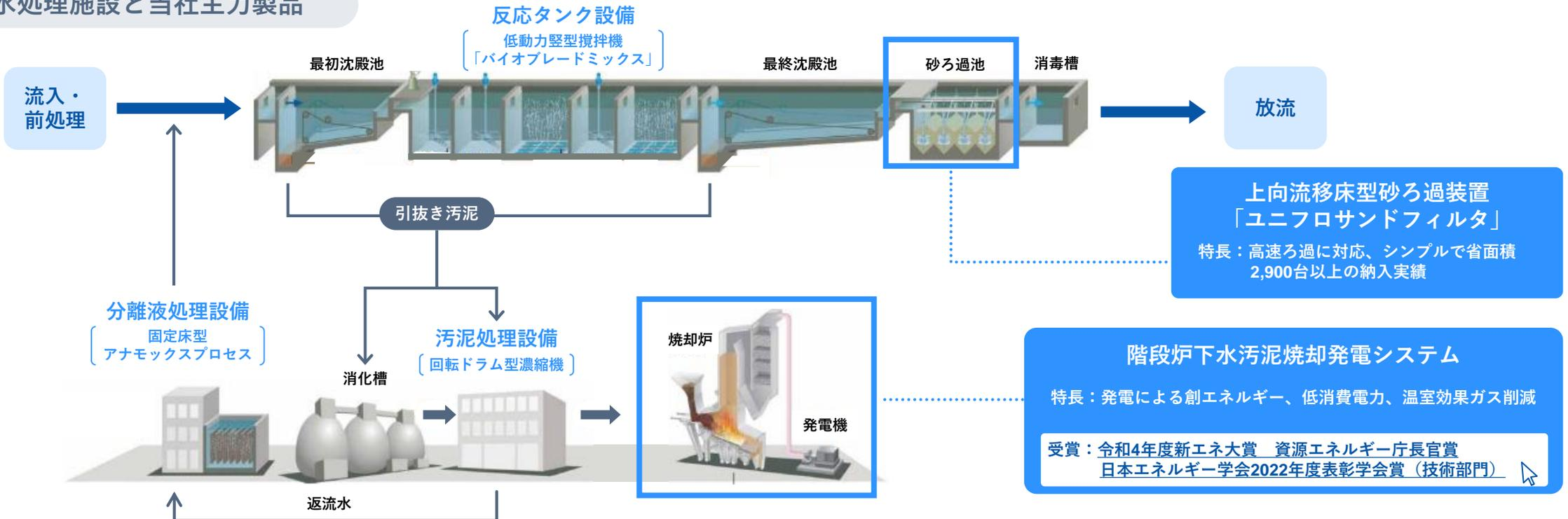
上向流移床型砂ろ過装置
